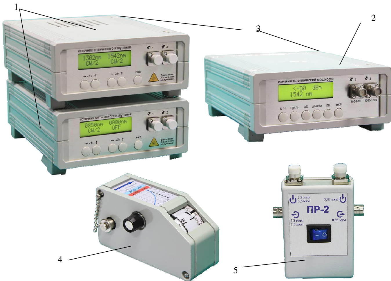
Рисунок 1 - Общий вид и места пломбирования РЭСМ-В 1 – источники оптического излучения; 2 – измеритель оптической мощности; 3 – место установки пломбы; 4 - аттенуатор оптический; 5 – преобразователь ПР-2.
