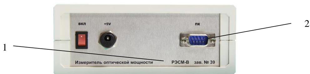
Рисунок 2 - Схема маркировки измерителя мощности и источника оптического излучения РЭСМ-В (вид сзади) 1 - место нанесения маркировки; 2 – разъем для связи с ПК.
