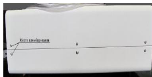
Рисунок 2 - Схема пломбировки счетчиков АССЧ 4705
