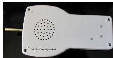
Рисунок 2 - Схема пломбировки счетчиков АССЧ 4705
