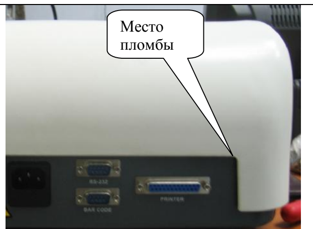
Рисунок 2 – Расположение пломбы. Анализатор мочи Н-100
