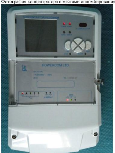
Фотография концентратора с местами опломбирования представлена на рисунке 1.
