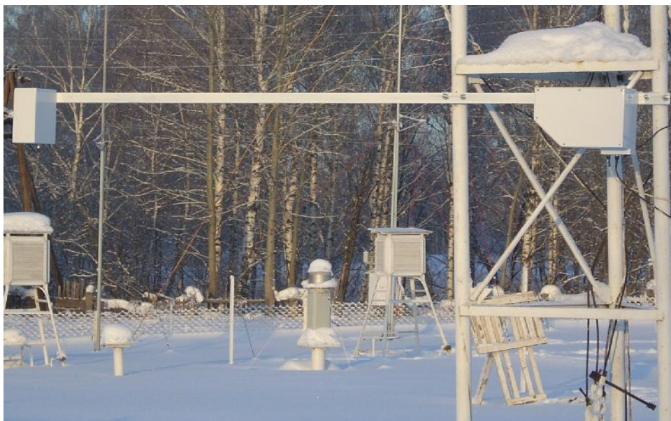
Рисунок 1. Снегомер автоматический бесконтактный «НАСТ».
