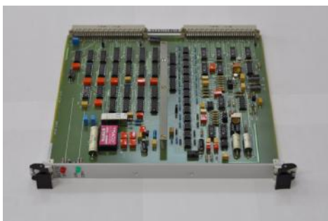
Рисунок 1 Фотография общего вида устройств сопряжения АВ12Р
