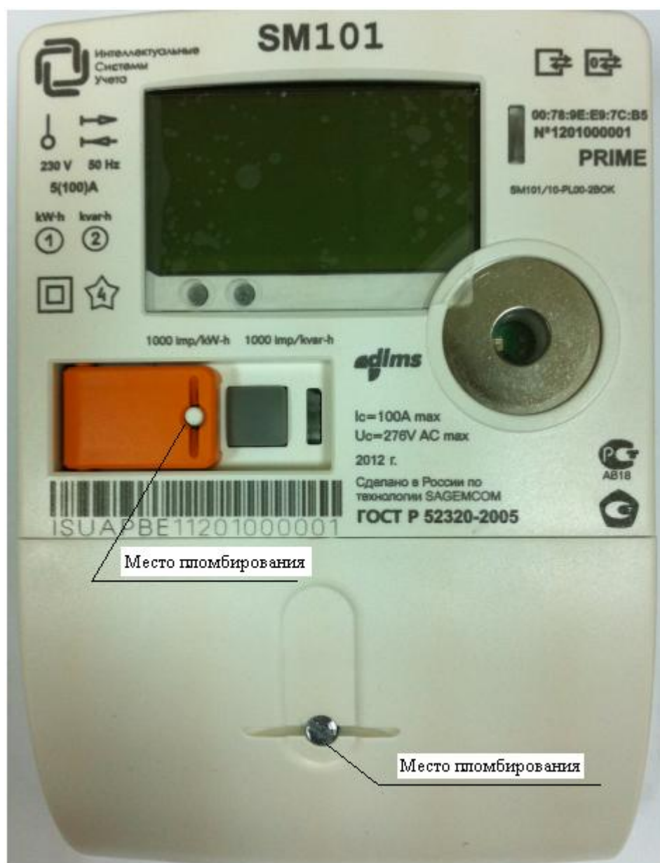
Рисунок 1 – Фотография общего вида счетчиков статических однофазных активной и реактивной электрической энергии электронных SM 101
