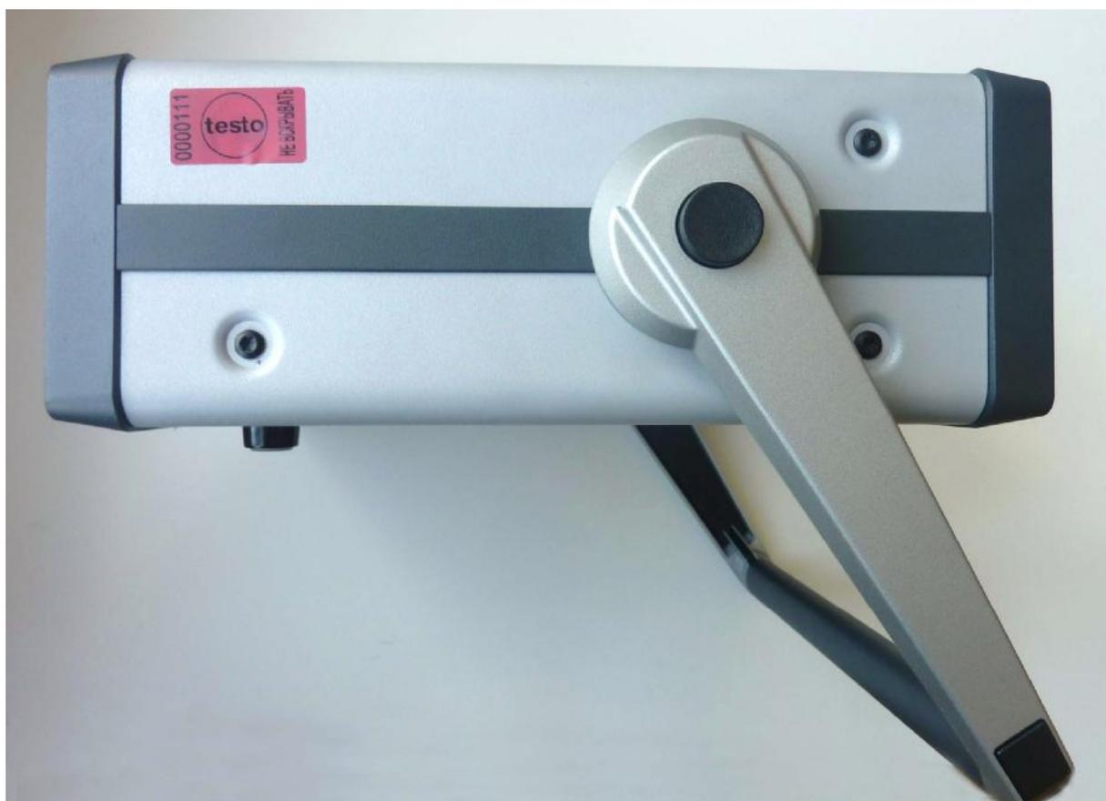
Рис. 2 Защита от вскрытия в виде наклейки на калибраторах давления Pneumator
