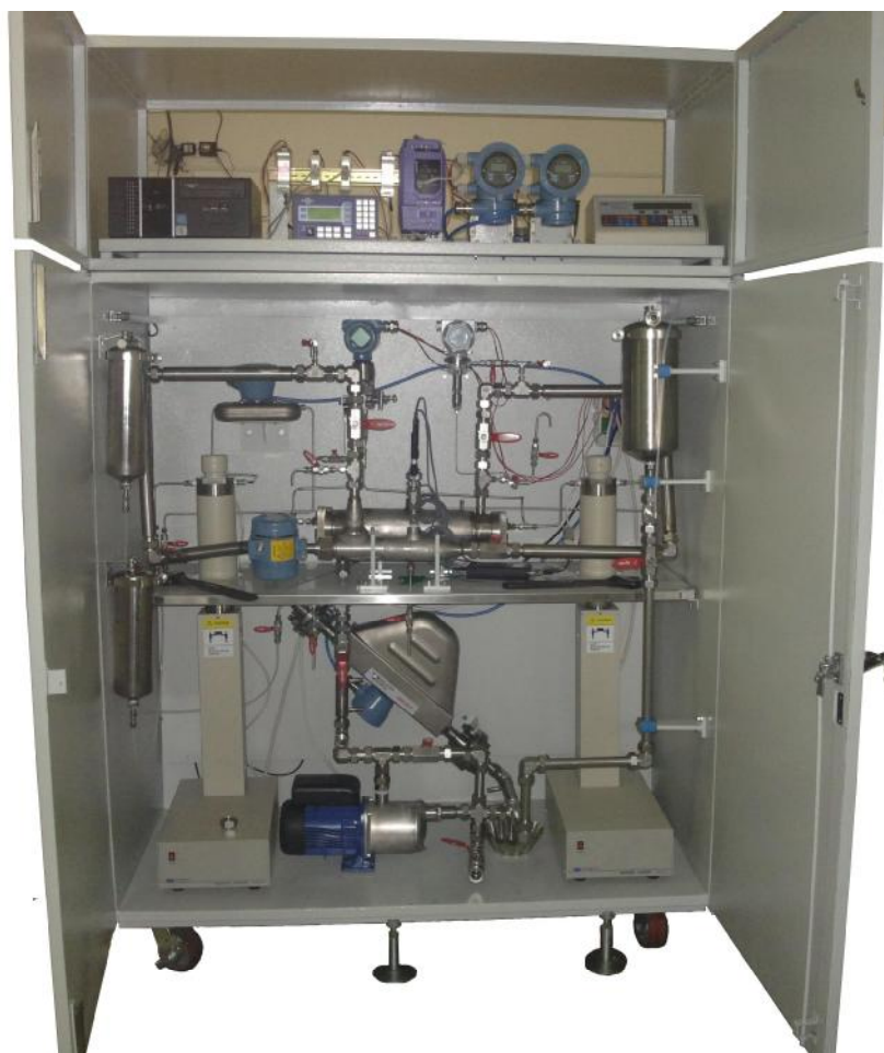
Рисунок 2 – Внутреннее содержание двухсекционного шкафа стенда АСПВ
