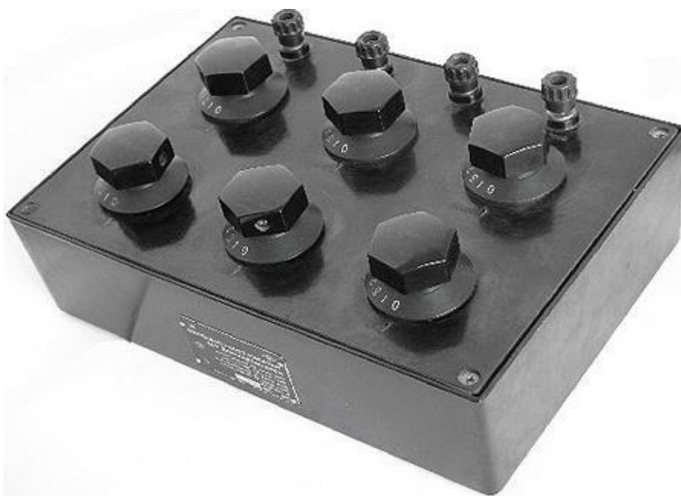
Рисунок 1 – Общий вид магазина сопротивлений
