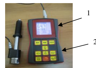
Рисунок 4. - схема пломбировки модификации ТКМ-359С 1,2 - места пломбировки
