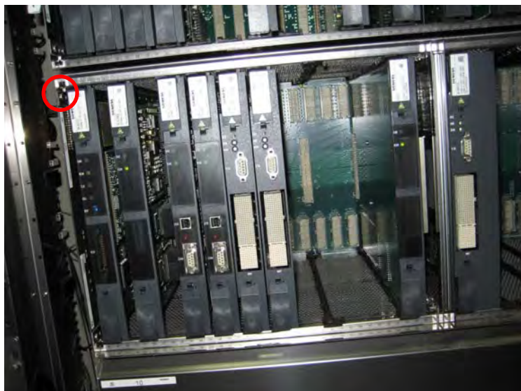
Рисунок 2 -Место пломбирования кассетного модуля (выделено)
