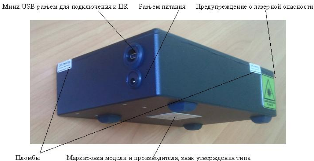
Рисунок 2 - Схема пломбирования и маркировки спектрометра
