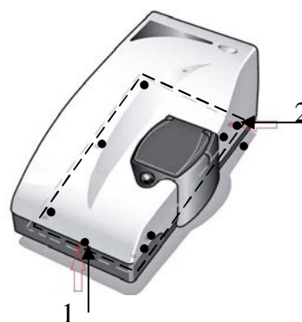
1 и 2 – места пломбировки
