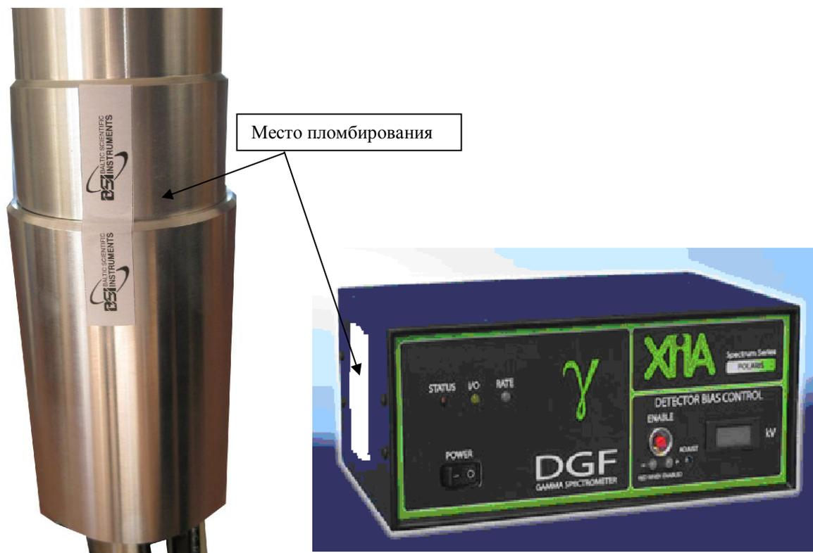
Вид спектрометра и места пломбирования
