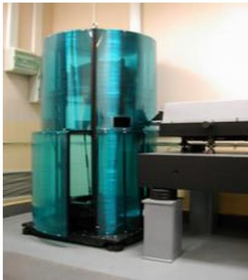
Рис. 1 – Внешний вид интерферометра фотоэлектрического «Физо»
