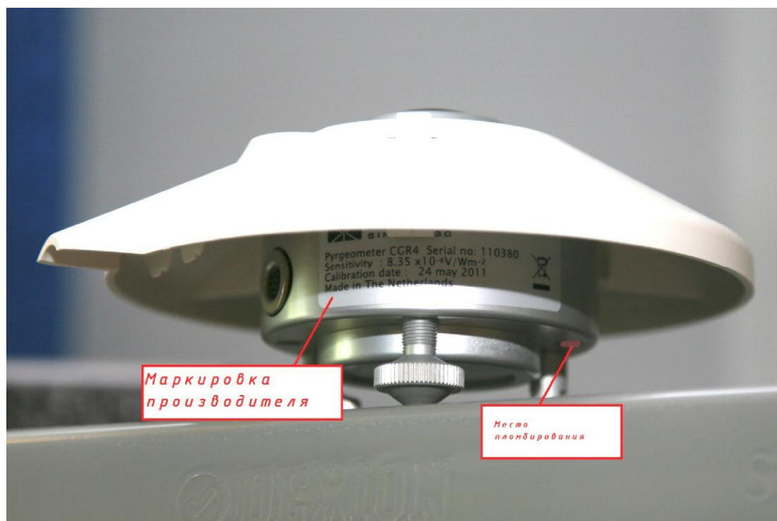
Рисунок 2 – Пиргеометр CGR 4. Место нанесения маркировки и пломбирования
