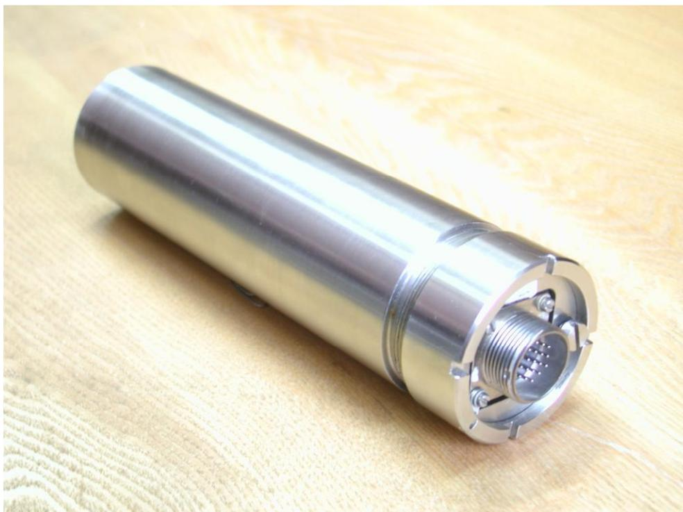
Рисунок 2 – Фотография блока детектирования БДРГ-42Р
