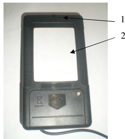
Рис. 2. Корпус радиометра - вид сзади 1 - место установки пломбы; 2 - место нанесения маркировки
