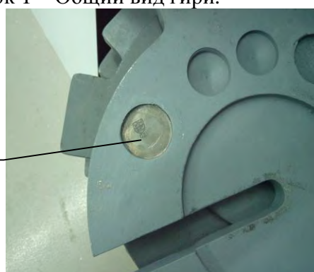
Рисунок 2 – Схема пломбирования от несанкционированного доступа и обозначение мест для нанесения клейма.
