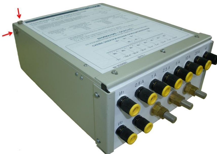
Фото 1 – Общий вид ТТ и места нанесения поверочного клейма.
