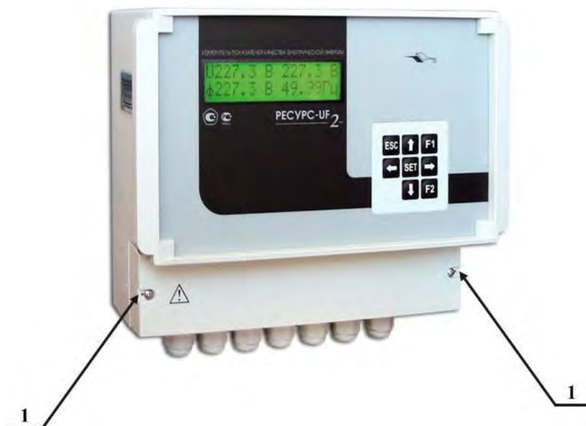
Рисунок 4 – Внешний вид и схема пломбирования от несанкционированного доступа выносного модуля щитового варианта исполнения (1 – места установки пломб от несанкционированного доступа к измерительным входам устройства)
