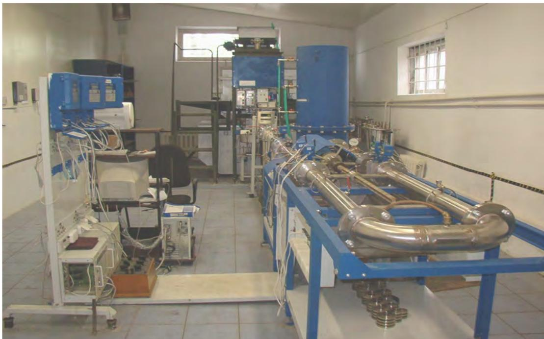
Рис.1. Общий вид установок поверочных «ВЗЛЕТ ПУ»
