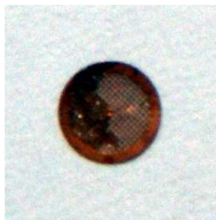
Рисунок 1 - Фото меры длины рельефной МПУ278нм для просвечивающей электронной микроскопии в футляре (1а), отдельно (1б)
