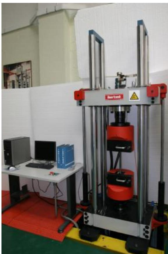
Рисунок 2 Общий вид машины POWERTEST B
