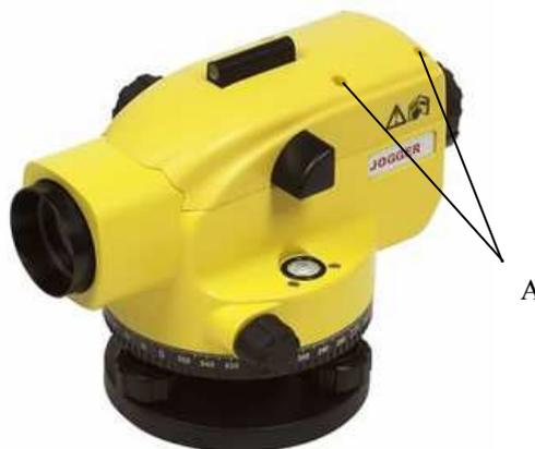
Для предотвращения несанкционированного доступа к внутренним частям нивелиров оптико-механических с компенсатором Leica Jogger производится пломбировка винтов на верхней панели в месте обозначенным «А».
