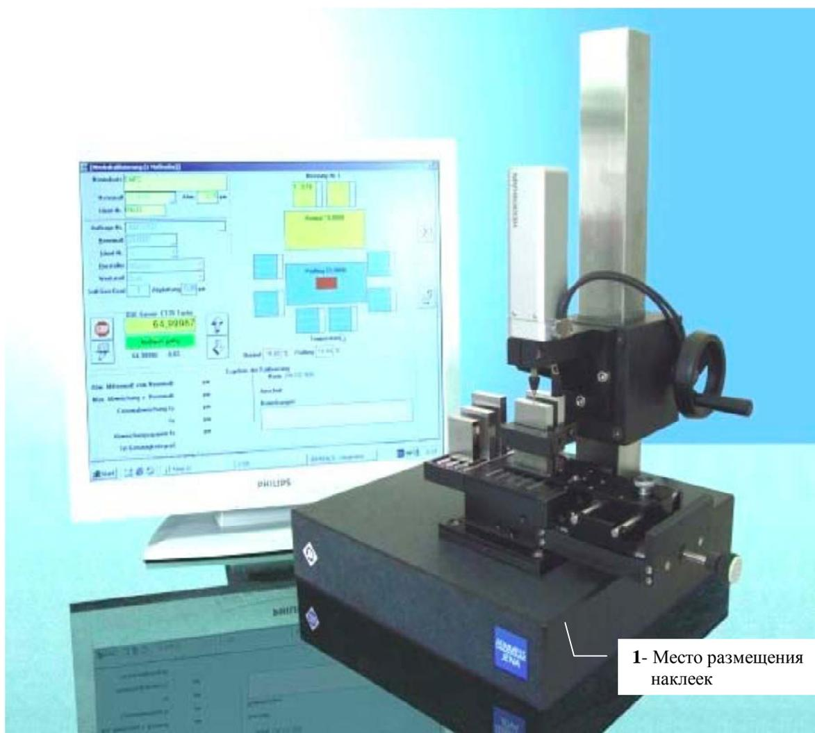
Рисунок 1 - Внешний вид компаратора EMP 25
