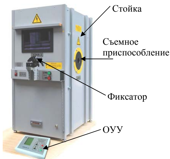
Общий вид установки
