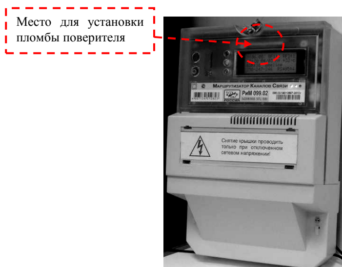
Рисунок 1 – Общий вид и место установки пломбы поверителя МКС
