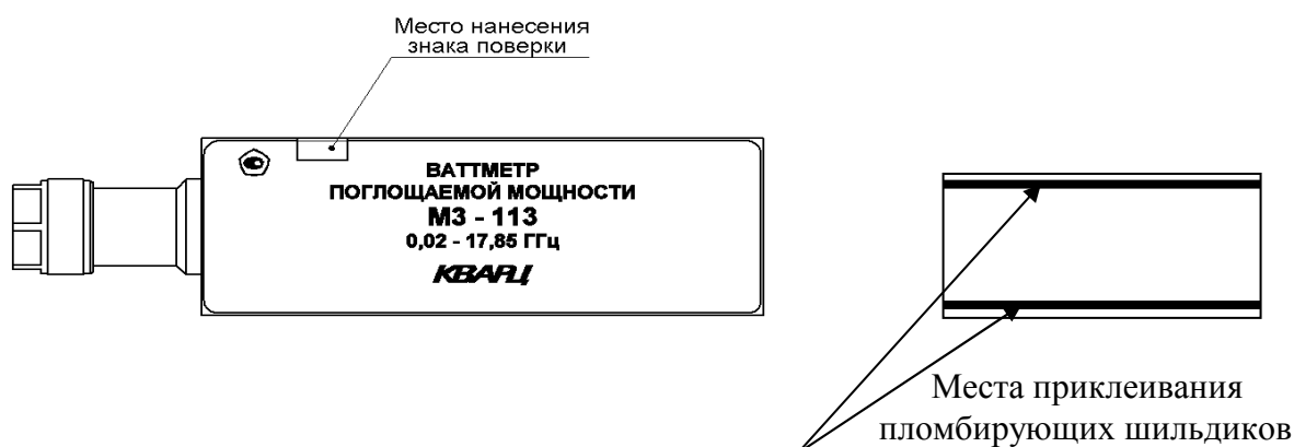
Рисунок 2 – Схема нанесения пломбирующего шильдика и знака поверки
