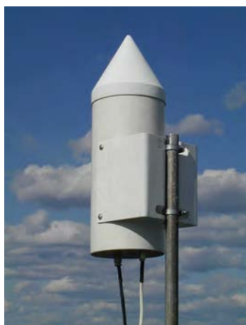
Рис. 1 Внешний вид осадкомера
