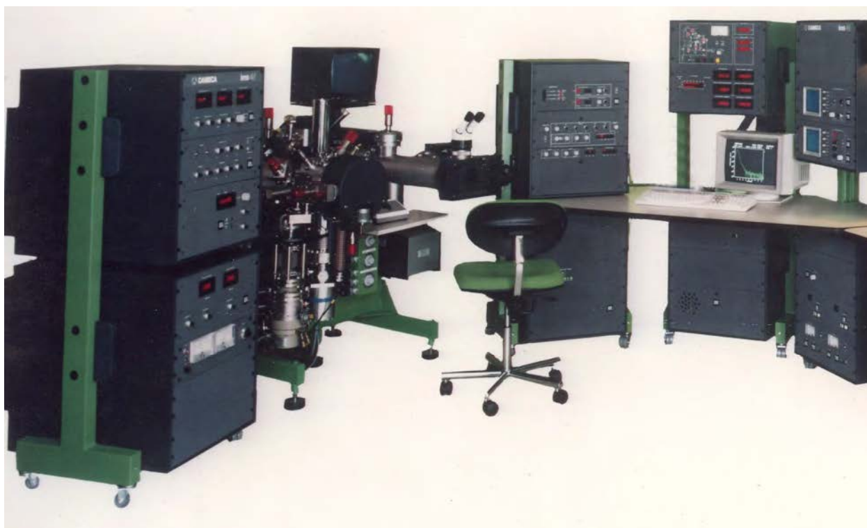
Рисунок 1 - Общий вид масс-спектрометра вторично-ионного микрозондового IMS-4f
