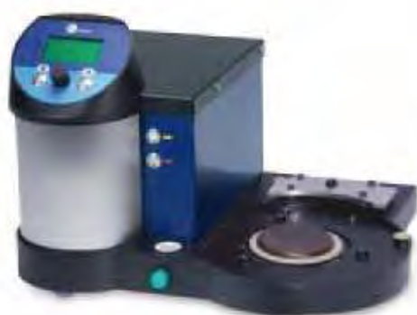
Рисунок 1. Анализатор температуры вспышки нефтепродуктов модели MULTIFLASH (базовый блок)
