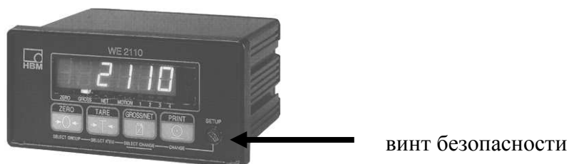
Рисунок 2 - Схема пломбировки WE2110
