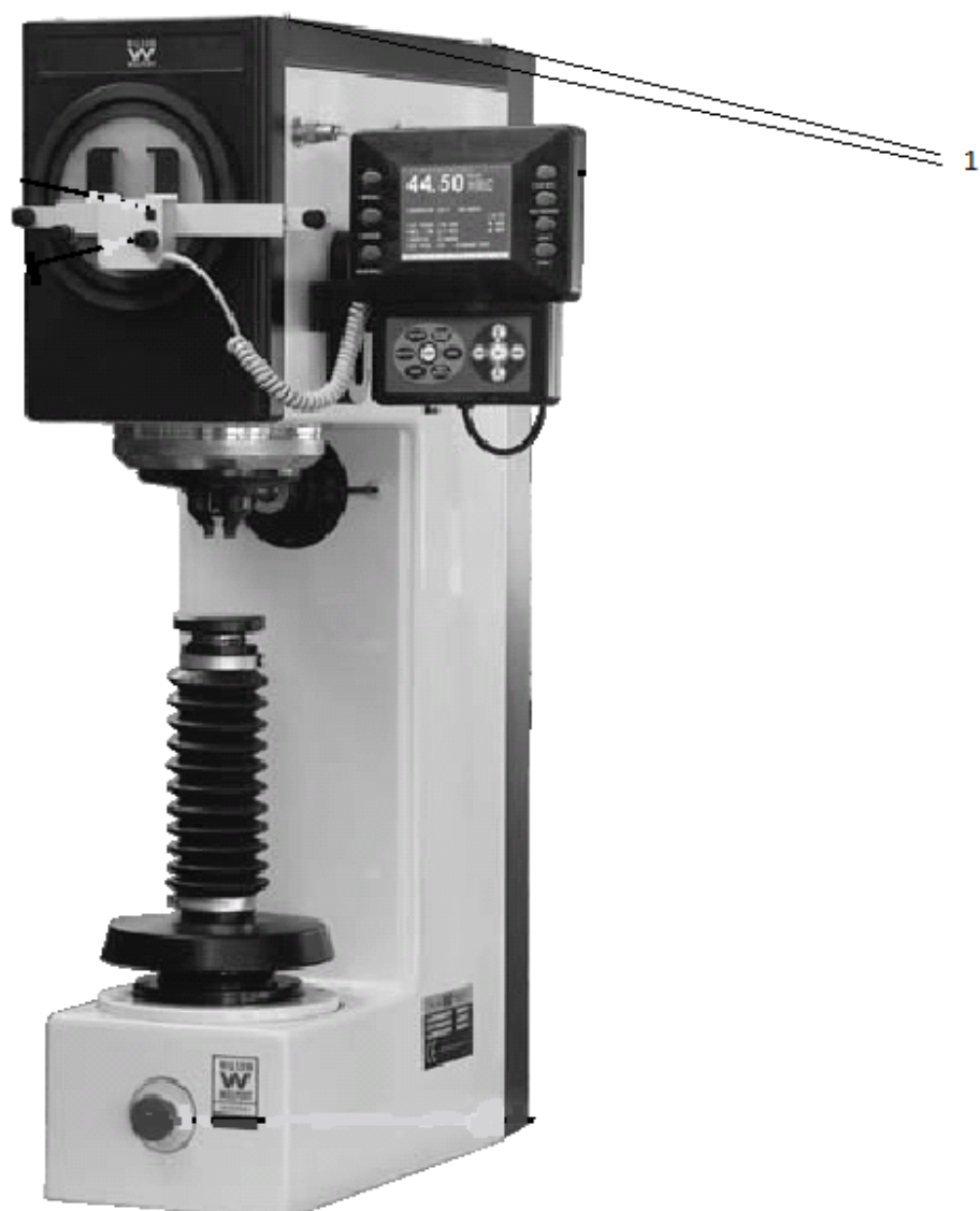
Рис.2. Твердомер стационарный универсальный UN930. 1 - места пломбировки.
