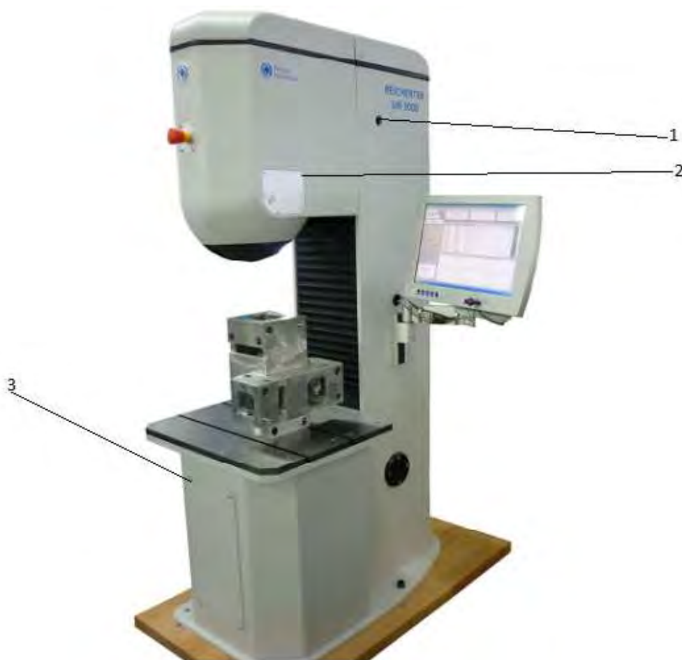
Рис.3. Твердомеры стационарные универсальные UN750, UN3000. 1, 2, 3 - места пломбировки.
