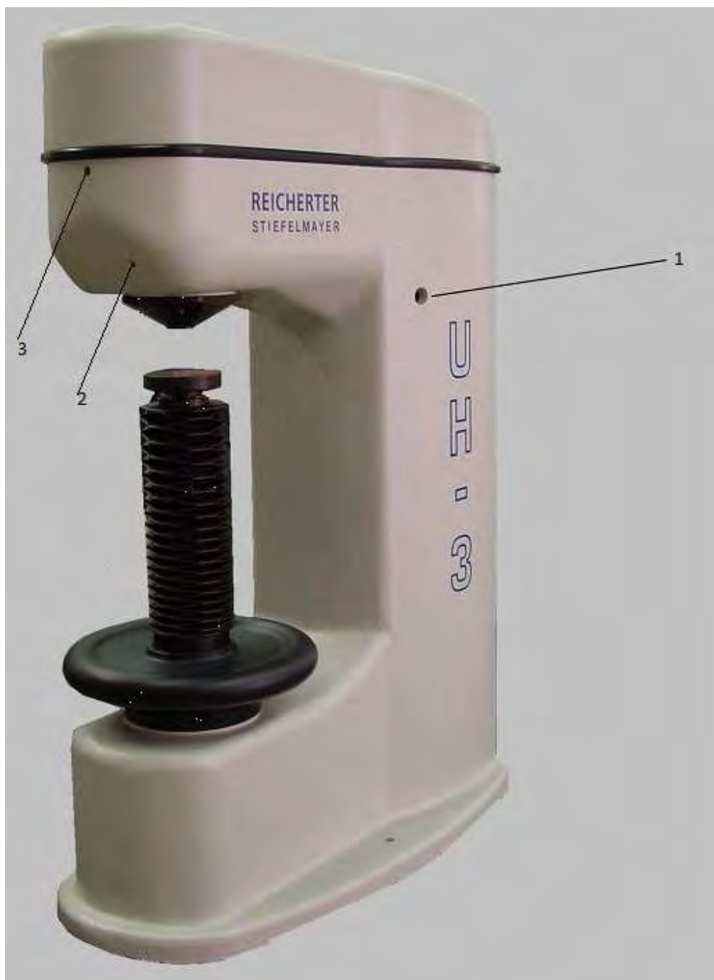
Рис.1. Твердомер стационарный универсальный UN250. 1,2,3 - места пломбировки.
