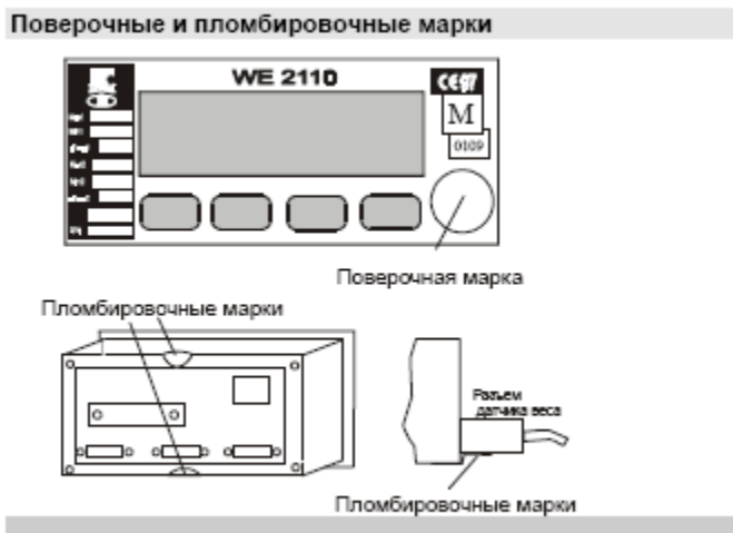
Рисунок 2 - Места наклейки поверочных и пломбировочных клеев.
