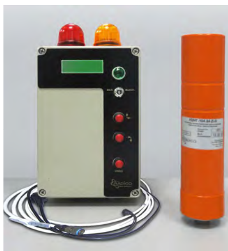
Рисунок 1 – Установка дозиметрическая для измерения мощности дозы гамма-излучения УДМГ-104.
