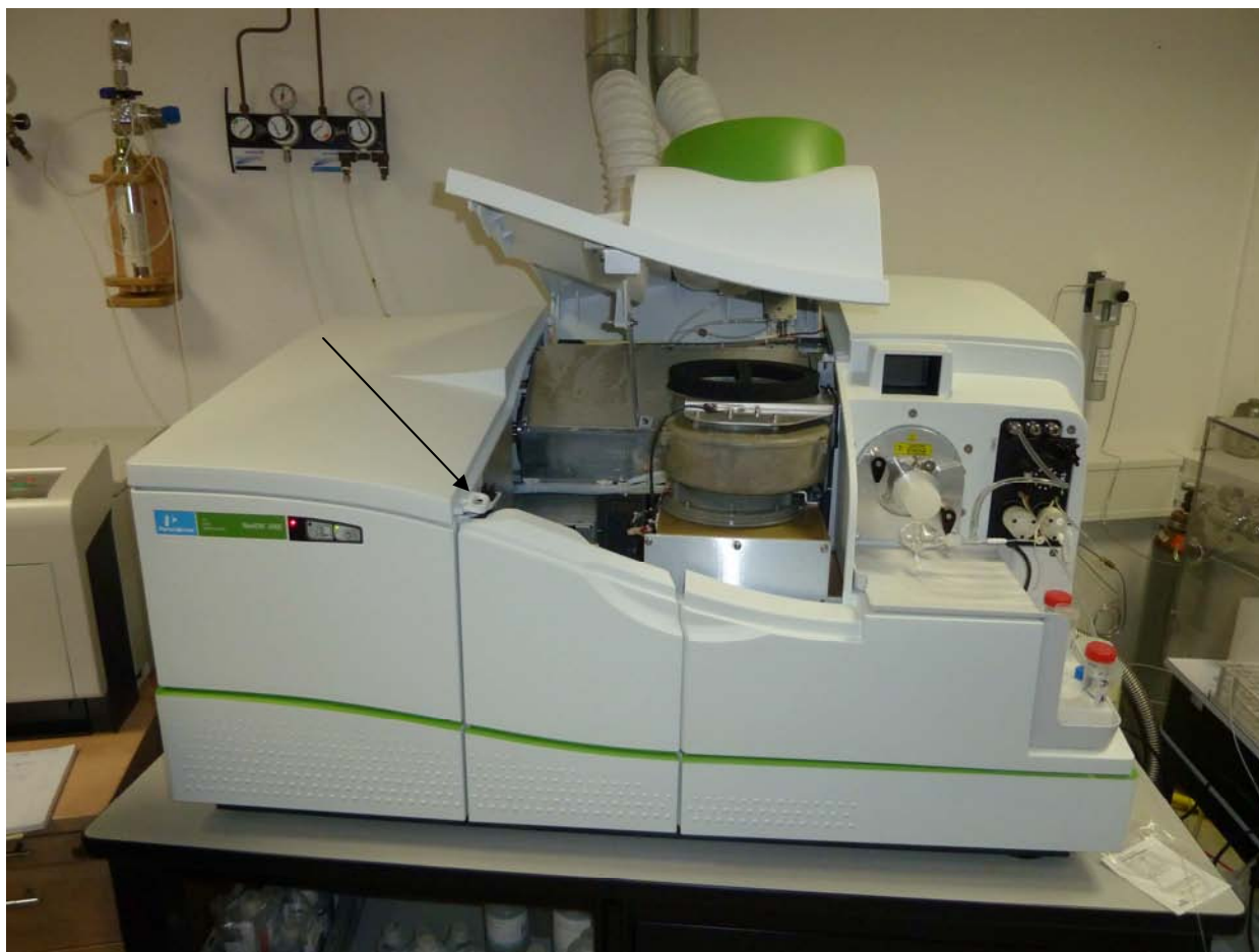
Рисунок 2 – Схема расположения блокировки от несанкционированного доступа (стрелка указывает на месторасположение датчиков блокировки под крышкой прибора)
