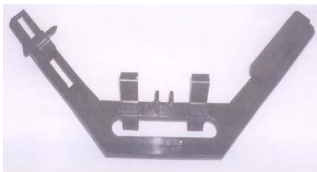
Штанген-шаблон НП надрессорной балки
