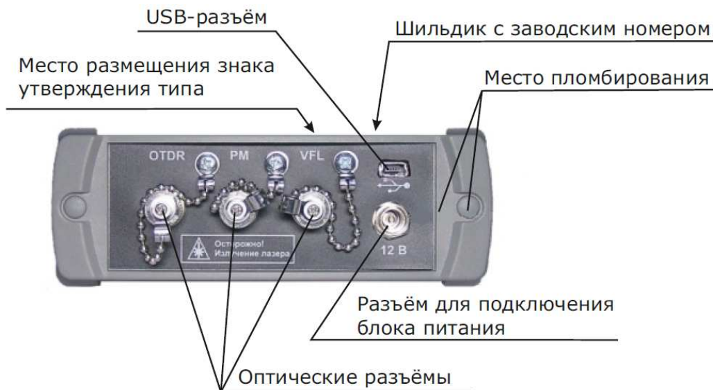
Рисунок 2 – Схема пломбирования и маркировки рефлектометра оптического VISA
