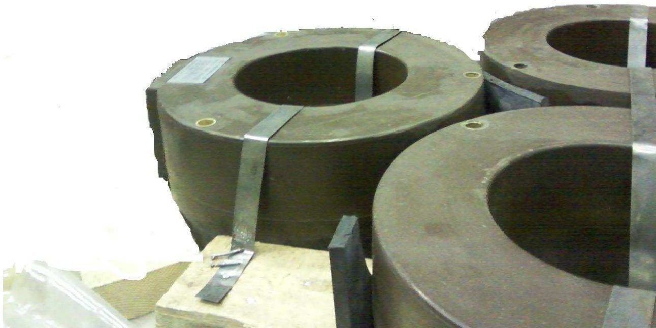
Общий вид трансформатора ТВЛ-10
