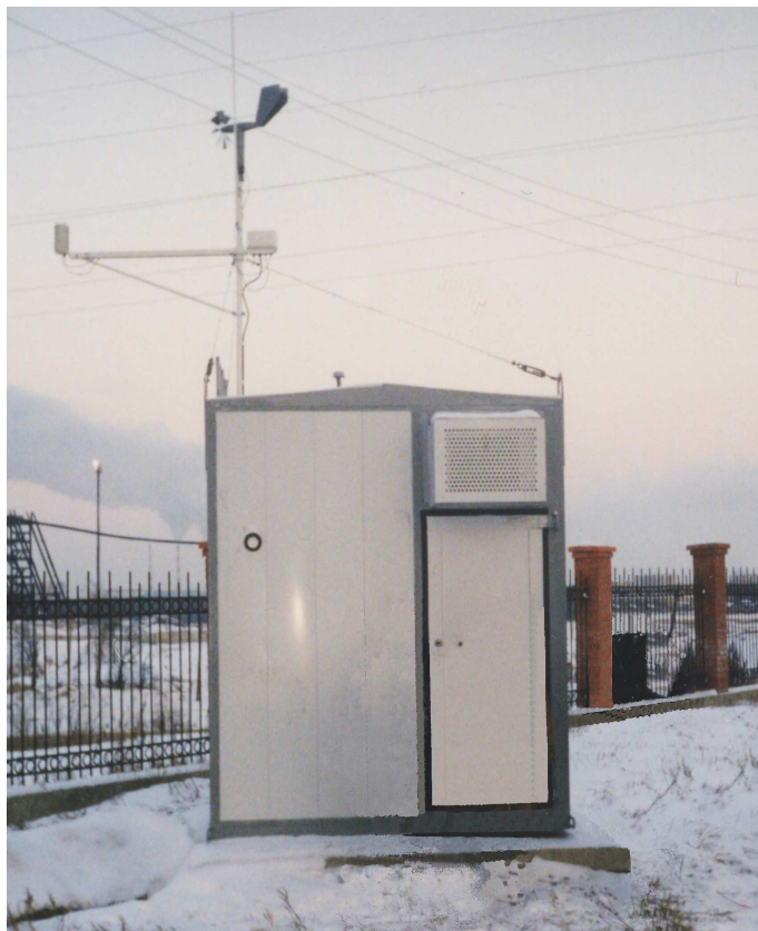
Рисунок 1 – общий вид станции контроля загрязнения атмосферного воздуха автоматической МР-28.
