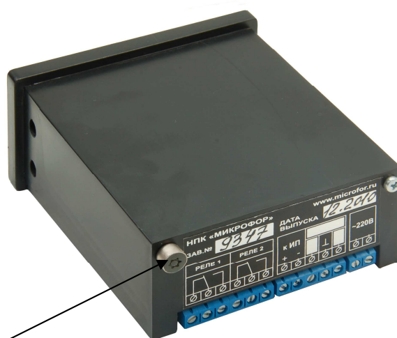
Рисунок 3. Место пломбирования термогигрометра ИВА-6Б, ИВА-6Б-К
