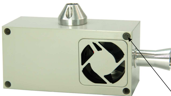
Рисунок 2. Место пломбирования термогигрометра ИВА-6НИ
