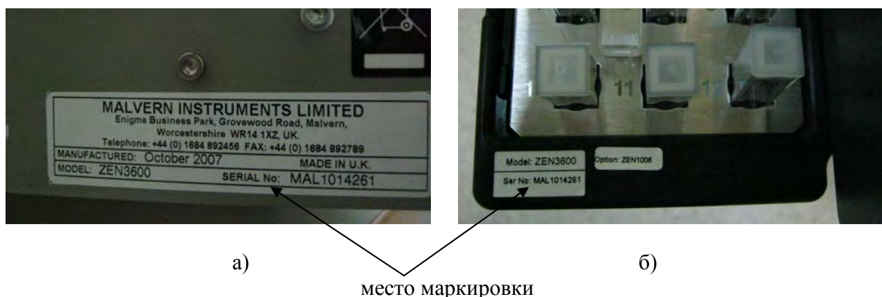
Рисунок 2 - Схема маркировки анализатора а) вид задней панели; б) вид со стороны кюветного держателя
