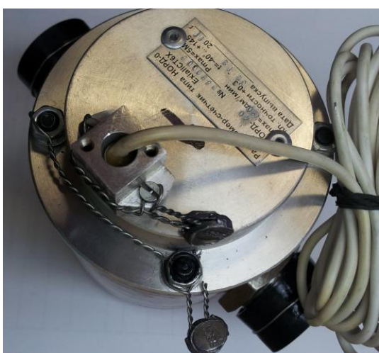
Рисунок 6 – Места пломбировки первичных преобразователей НОРД-О-Р, НОРД-О-А и НОРД-О-РЭ
