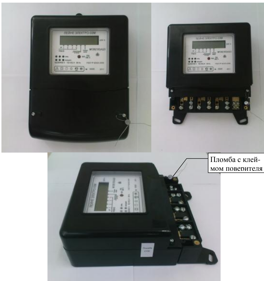
Рисунок 1 – Фото общего вида счетчика
