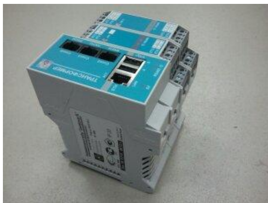
Рисунок 2 – прибор микропроцессорный Трансформер – ML, укомплектованный модулями А8У, А5-1, МВ БП24-5
