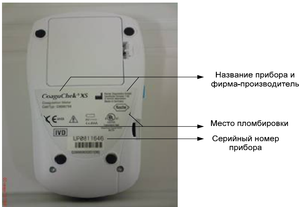
Рисунок 3 – Схема маркировки и пломбировки коагулометра портативного CoaguChek XS
