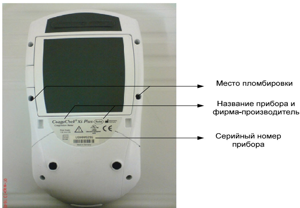
Рисунок 4 – Схема маркировки и пломбировки коагулометра портативного CoaguChek XS Plus
