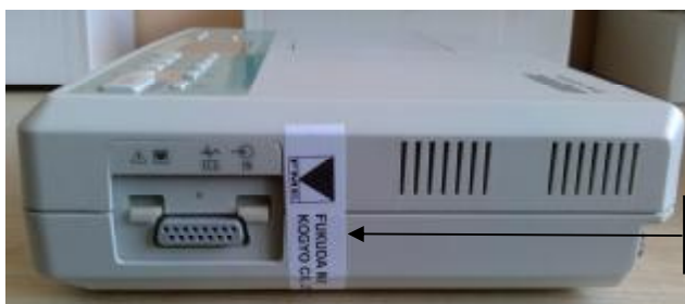
Рисунок 3 – Место пломбировки электрокардиографов
