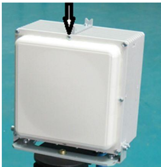
Рисунок 2. Место пломбировки имитатора
